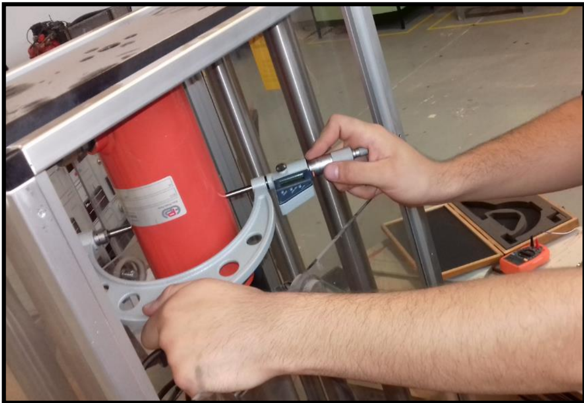
Figura 5.- Medición de diámetro exterior del cilindro hidráulico de simple efecto.
