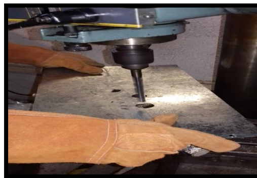
Figura 15.- Proceso de perforación para colocar los elementos del panel de control.
