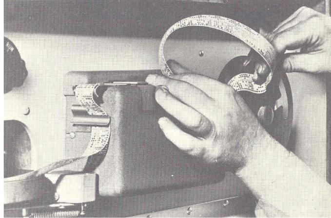
**Imagen 2.- Colocación de cinta perforada en captadora de máquina de Control Numérico**
