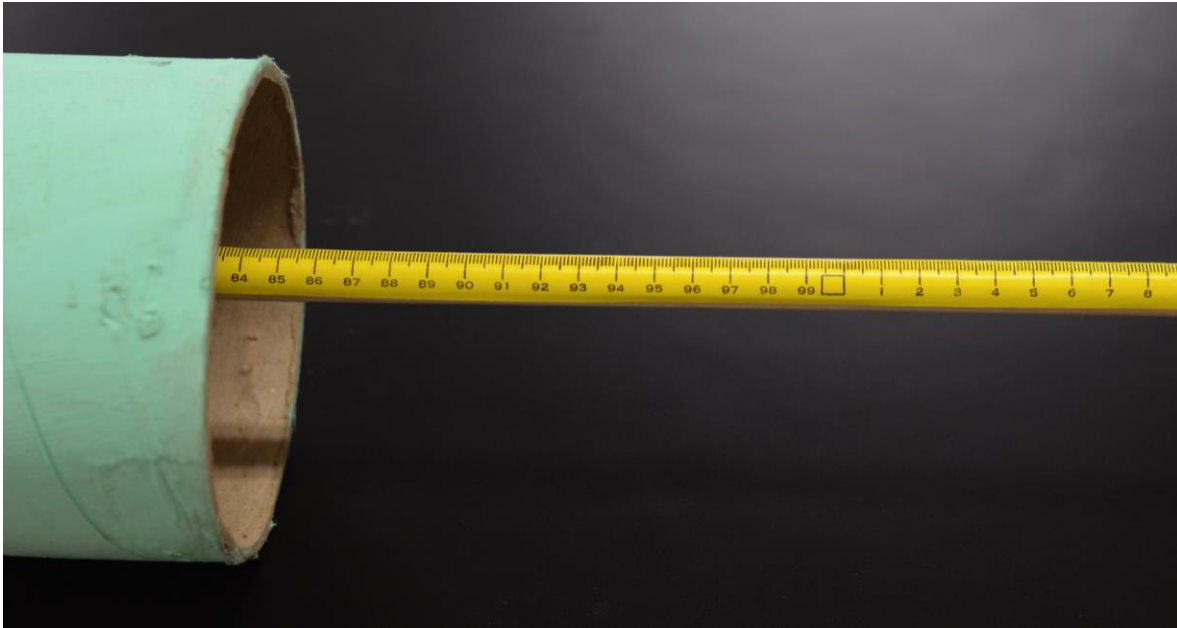
Figura 5. Detalle de la cinta métrica localizada directamente en el pistón.
