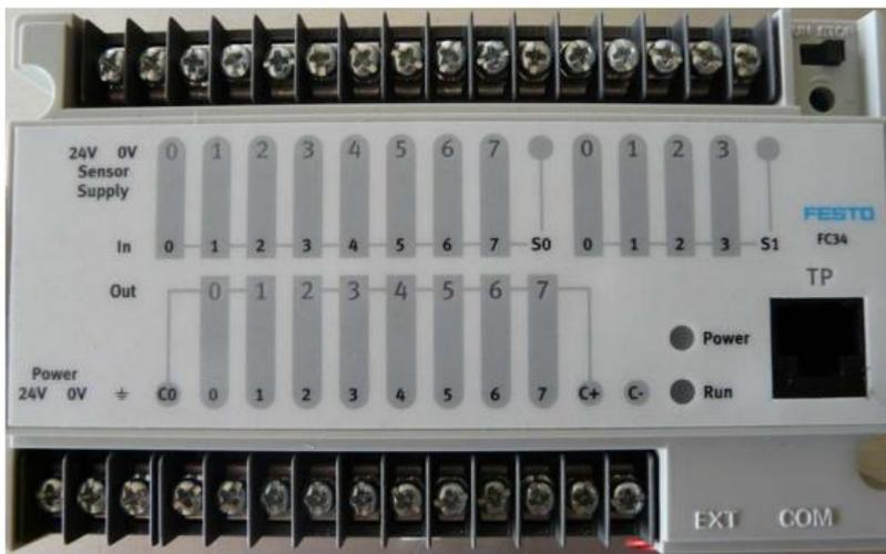
Figura 4. Controlador lógico programable de la marca Festo® modelo FC34.
