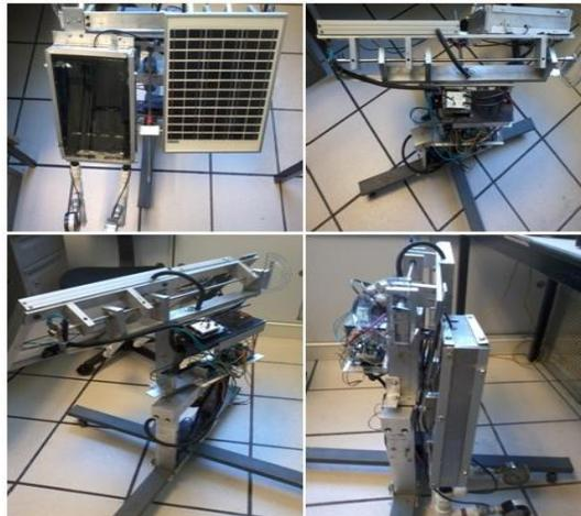
Prototipo de seguidor solar híbrido.
