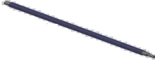
13.- Tornillo ACME mecanismo de movimiento Altura Solar
