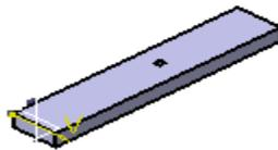
5.- Parte lateral que realiza el movimiento altura solar
