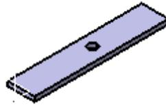
4.-Parte superior de la base móvil, para realizar el movimiento Azimut
