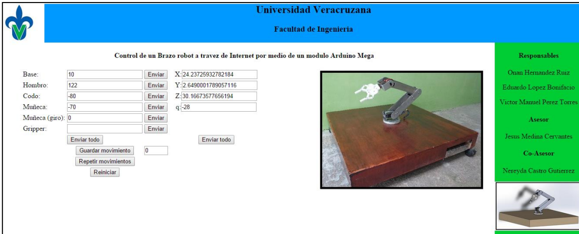
Figura 14. Página web para el control de un brazo robot (Hernández, López, & Pérez, 2016).
