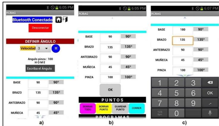
Figura 20. Layout para el modo de operación manual (Reyes J. M., 2015).
