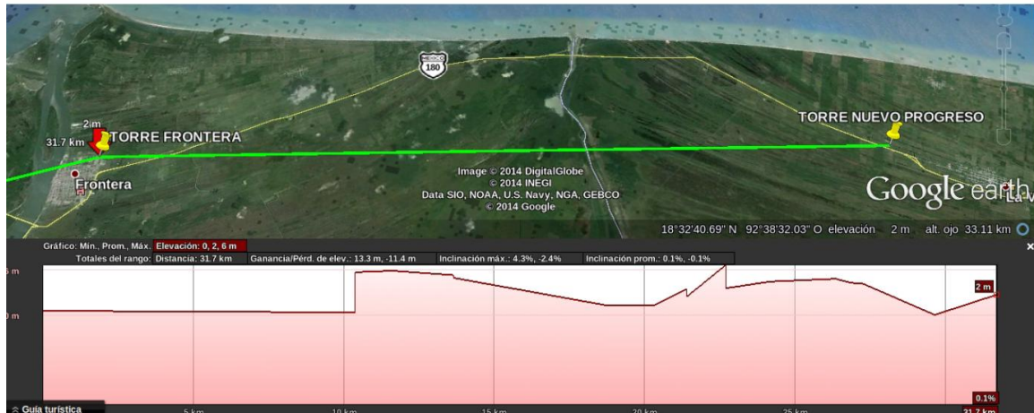
Figura 15. Enlace Frontera – Nuevo Progreso
