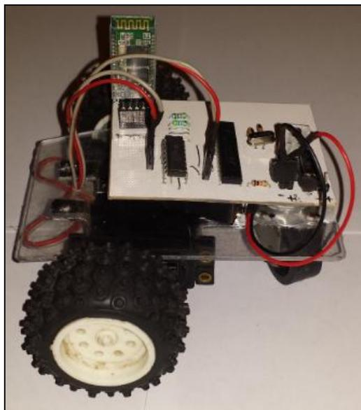
Figura 2. Robot móvil controlado vía bluetooth.
