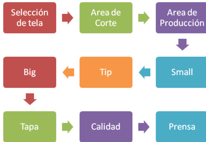
Figura 1. Proceso de fabricación de sacos de Polipropileno
