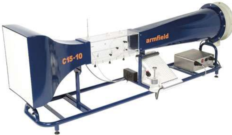
Figura 4. Túnel de viento subsónico Armfield C-15.
