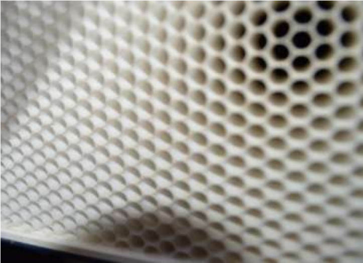
Figura 5. Panel instalado en zona de contracción.
